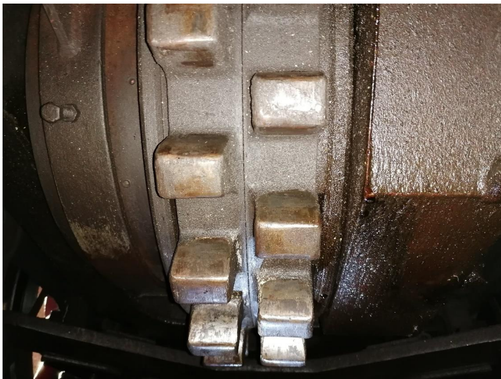
Obrázek 3 - Pohled na ozubnicové kolo na lokomotivě řady 715
